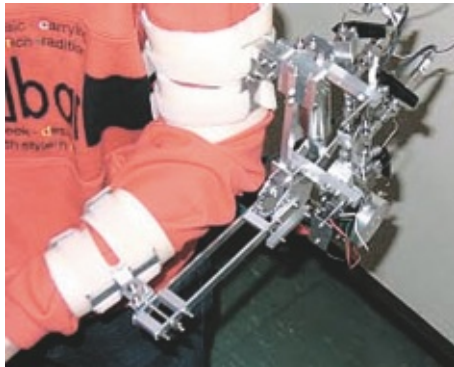
図4. MH アクチュエータを利用した肘関節リハビリ機器
