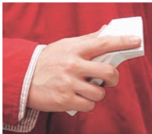
図 2. 振動子マトリクスを装備した触覚インタフェース
