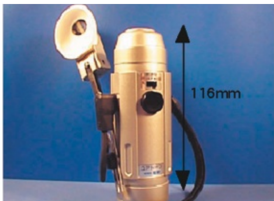
図 1. 抑揚を制御できる改良型電気式人工喉頭
