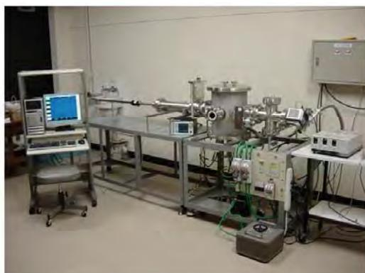
図1. 自作のEL発光素子作製装置
