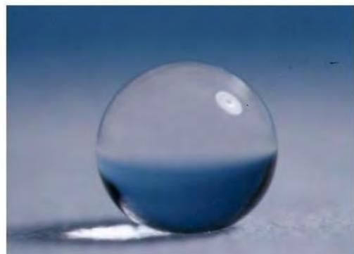
図1. 超撥水フラクタル表面上の水滴。材料はAKDで、接触角は $174^\circ$
