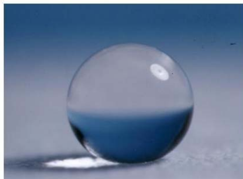
図1. 超撥水フラクタル表面上の水滴。材料はAKDで、接触角は 174^\circ
