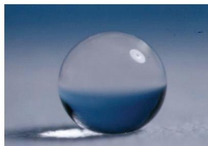
図1. 超撥水フラクタル表面上の水滴。材料はアルキルケテンダイマーで、接触角は $174^\circ$
