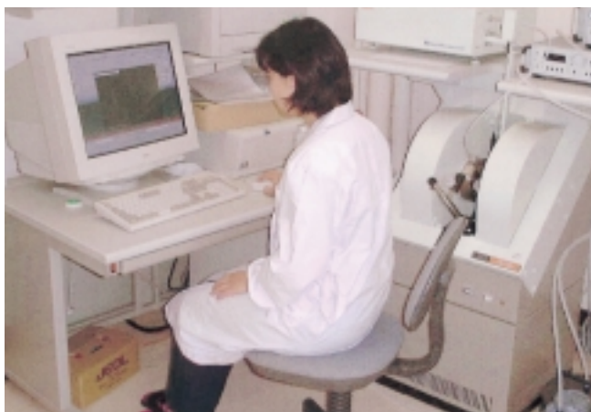
電子スピン共鳴装置による超薄膜の電子状態評価
