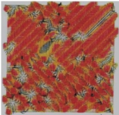
2次元TDGL方程式に基づく、BaTiO 3 の90°ドメインシミュレーション結果
