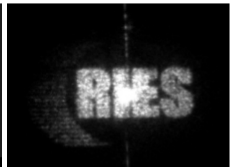
図3.空間変調器を用いて形成したパターンの光学顕微鏡像 Figure 3. Optical micrograph of patterns prepared by using dynamic holograms
