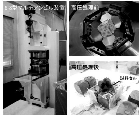
図5 6-8型マルチアンビルセル
