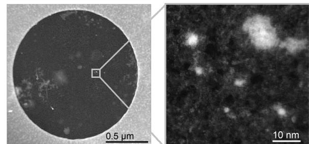
図4 TEMグリッドに転写したグラフェンの収差補正電子顕微鏡像。白く見えるのは、Cuを含むコンタミネーション。X線測定において、バックグラウンド信号の原因になる。
