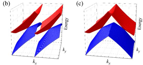
図4 (b) Positive tilt chirality、(c) Negative tilt chirality の場合の Type-II ワイル半金属の電子構造の模式図。
