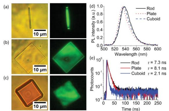
図2 各種形状のペロブスカイトナノ結晶における、発光挙動の形状依存性データ【資料4-1-10】
