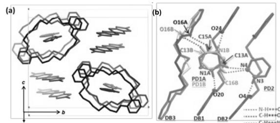
図 1. 1 の 118 K での結晶構造。(a) 1 のパッキング構造。(b)  $pdazH^+$  と dibenzo[24]crown-8 の間の  $N\text{-H}\cdots O$  および  $C\text{-H}\cdots O$  相互作用と  $pdazH^+$  分子間の  $C\text{-H}\cdots N$  相互作用。
