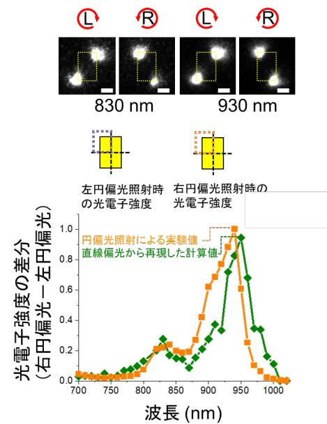
図3 左右円偏光照射時の近接場の電場増強に基づく光電子放出強度の空間分布(上段)とその差スペクトル(下段)。上段黄色点線はナノ構造の位置を表す。下段の光電子強度差分はオレンジが円偏光照射時に実際に得られたスペクトルで、最大値を1で規格化している。緑色のスペクトルは今回報告したモデルを用いて再構築した計算値。
