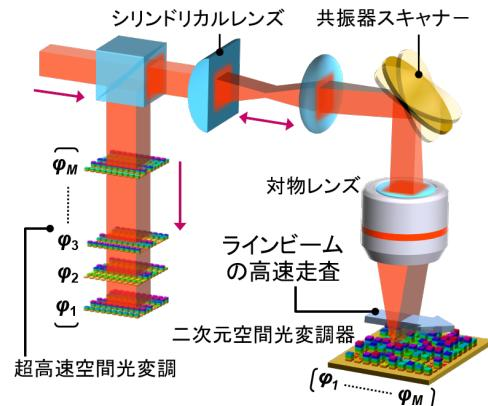
図3 超高速空間光変調手法。
