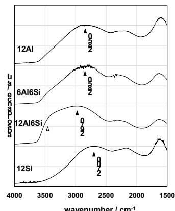
図2 APS 後のアルミニケイリン酸塩ガラスの赤外吸収スペクトル
