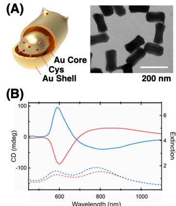
図1. (A) キラル分子を導入したCore-Gap-Shell型ナノ粒子のイメージと透過電子顕微鏡像、(B) キラルプラズモニックナノ粒子のCDと消光のスペクトル
