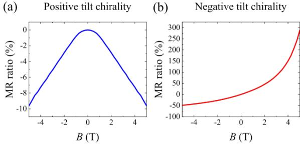
図 5 (a) Positive tilt chirality の場合と(b) Negative tilt chirality の場合の縦磁気抵抗比の磁場依存性。
