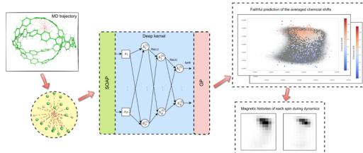
図4. 核スピンの時間的平均化学シフトを予測する為の機械学習スキーム。最初に、核スピンの局所環境が不変量ベクトルにマップされている。次に不変量ベクトルがディープカーネル( $D = 840, P = 1000, Q = 50, R = 2$ が使用されている)により低次元空間にマップされガウス過程により予測が行われている。深層カーネルの出力における低次元のマッピングは、ダイナミクス中の核スピンの磁気環境を特徴づけるフィンガープリントを構築する為に使用されている。
