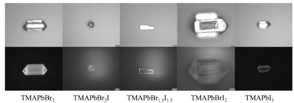
図6. TMAPbBr<sub>3-x</sub>I<sub>x</sub> の環境光（上）および紫外光（ex = 330~380 nm で励起、下）下における結晶。
