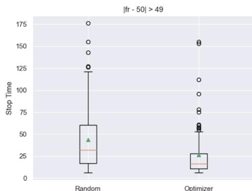
図 21. シミュレーション実験を繰り返し行った際の、ランダムな選択を行った時の停止時間(左、中央値 32.5 回)とベイズ最適化を行った時の停止時間(右、中央値 16.5 回)の分布
