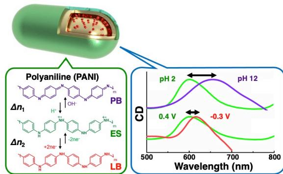
図2. polyaniline で表面を被覆した Core-Gap-Shell 型キラルプラズモニックナノ粒子の pH および電位変化による CD スペクトルの変化
