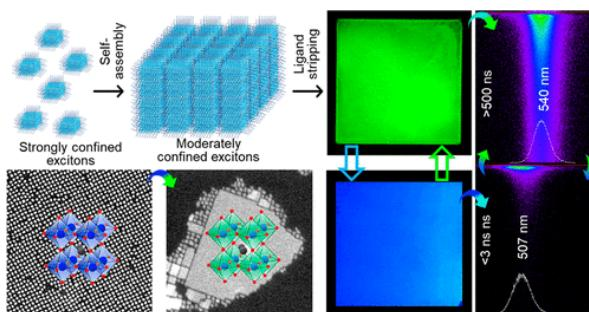
図3 自己組織化したホルムアミジニウム臭化鉛 ( $\text{FAPbBr}_3$ ) 量子ドットの、機械的に変化する励起子およびフォトルミネッセンス解明【資料4-1-1】
