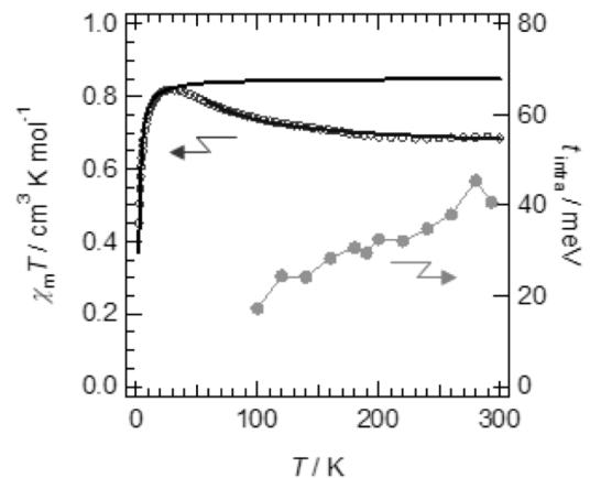
図3. 結晶 1 のモル磁化率の温度依存性 ( $\chi_m T$ 、左軸)。ふたつの実線は S-T 热励起モデルを用いたフィッティングであり、それぞれ  $J / k_B = -1.85$  と  $(-0.396 T + 15.5) \text{ K}$  をパラメータとする。両モデルともランデ  $g$ -因子は 2.13。右軸は二量体内トランスファー積分 ( $t_{\text{intra}}$ ) の温度依存性。
