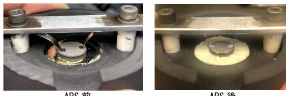
図1 Alkali-Proton Substitution (APS) 法によるリン酸塩ガラスの処理前後の写真
