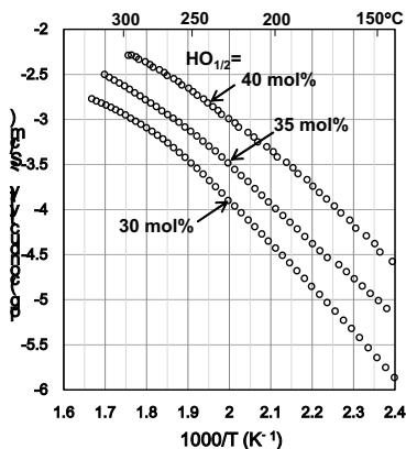
図8 結晶化に対して安定なアルミニケイリン酸塩ガラスの APS 後の伝導度のアレニウスプロット
