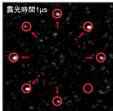
図4 開発空間光変調手法による光スポットの超高速走査。
