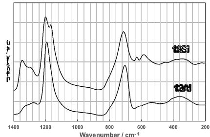
図5 APS前の12Siおよび12Alのラマン散乱スペクトル
