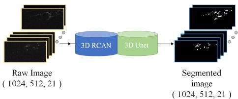
図8 合成ネットワークの概要図
