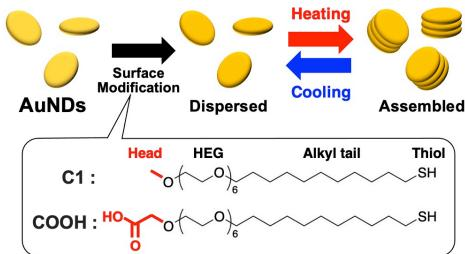
図3. 金ナノディスク (AuND) の温度応答性分子による表面修飾、および温度変化による集合-脱集合化挙動の模式図
