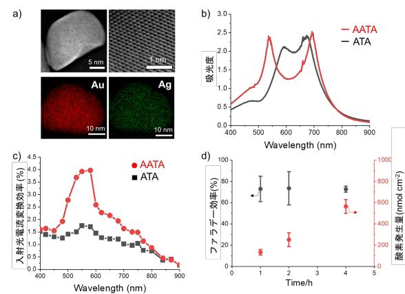
図 1 (a) 金銀合金ナノ粒子の透過型電子顕微鏡像（上）とエネルギー分散型 X 線分光による元素マッピング（下）。(b) AATA・ATA 電極の吸収スペクトル。吸光度は 1 で 90%、2 で 99% の光を吸収していることを指す。(c) AATA・ATA 電極を光陽極として用いた際の入射光電流変換効率。(d) AATA に可視光（波長 400nm 以上）を照射した際の酸素発生量とファラデー効率。
