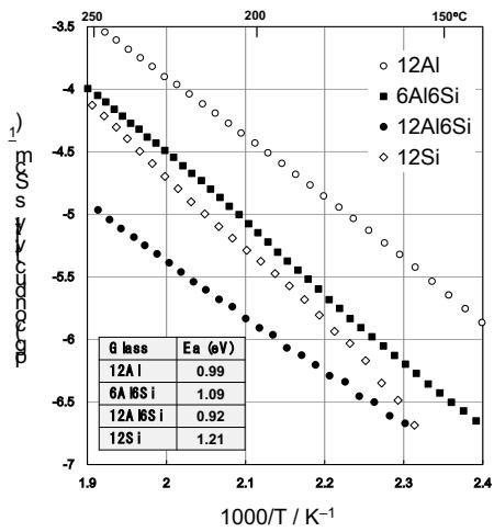
図3 APS後のアルミノケイリン酸ガラスの伝導度のアレン
