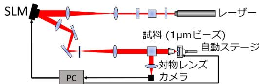
図6 細胞追跡・制御システムの光学系。
