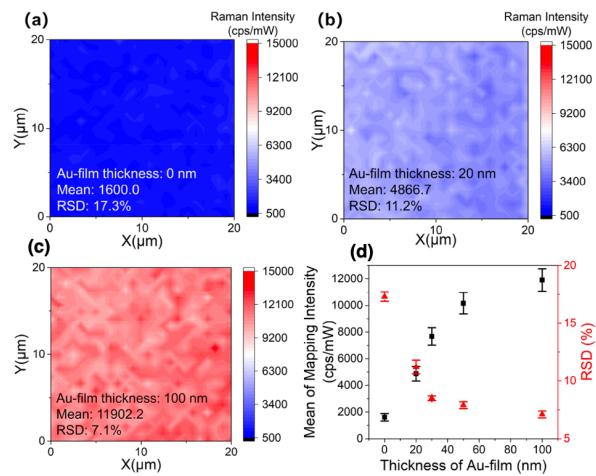
図2 ATAの金反射膜の膜厚を変化させたSERSチップを用いて計測したラマン強度マッピング：(a)金反射膜の膜厚0 nm、(b)20 nm、(c)100 nm。(d)金反射膜の膜厚に対するマッピングされたラマン強度の平均値、およびその相対的標準偏差。
