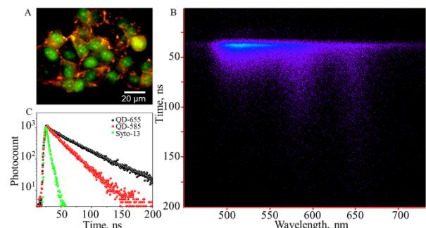
図4 シリカ粒子と免疫蛍光量子ドット複合体による細胞蛍光染色のイメージと、時間分解蛍光測定法による検出例【資料4-1-2】
