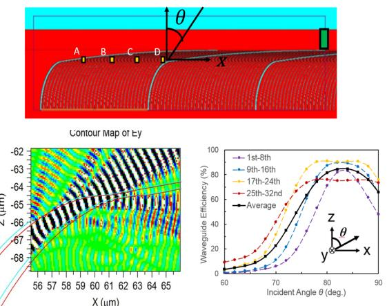
図2 離散的併進対称性導波路 (DTSWG) のシミュレーション。上) 構造図、系統図、左下) 縦長楕円から横長楕円へ切り替わる部分での光の導波の様子、右下) 縦長楕円から横長楕円へ切り替わる部分に光源を置いて出射角  $\theta$  を振ったときの2次元導波路内 (上図右上の緑色のモニター) への到達効率の計算結果。
