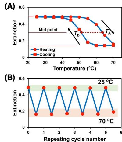
図4. 温度変化に対する金ナノディスクの表面プラズモンの変化. (A) L-LSPRピークの消光度の変化と(B) 25°C–75°C間の繰り返し温度変化における可逆性
