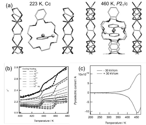
図4. (a) 1の結晶構造（左 223 K, 右 460 K）。(b) 誘電率の温度周波数依存性、(c) 焦電流の温度依存性。
