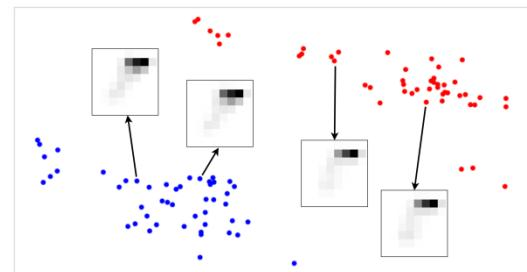
図5. ディープカーネルの出力によって与えられるプロトン局所環境分布の多次元尺度構成法による埋め込み。それぞれの点はダイナミクスの間、一つの核スピンが経験する環境の分布と対応している。2点間の距離は、対応する離散化された分布間のearth movers distanceを意味する。分布例は四角のなかにハイライトされている。プロトンの磁気履歴は赤と青でハイライトされた2つの異なるグループからなっている。
