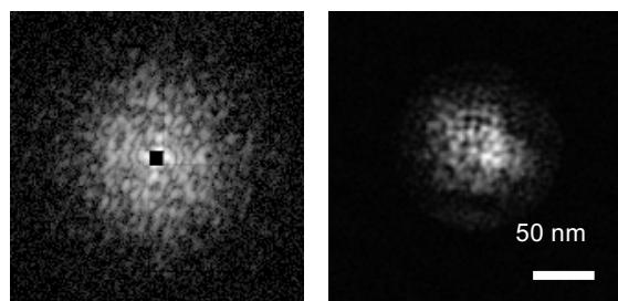
図1 触媒インク溶液のSACL Aによる観察例。
