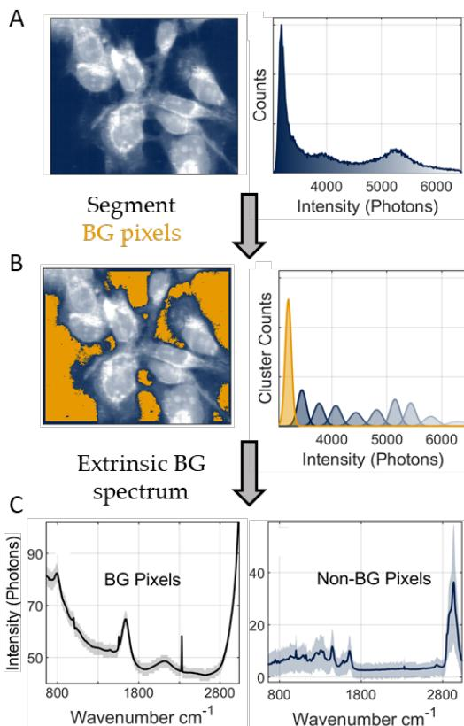
図 8. Extrinsic Background Correction (EBC)のデモンストレーション. A) 実験で得られたラマンイメージに対して、波数 2840-2980 cm<sup>-1</sup> の範囲においてラマン強度を合計した画像、および対応する強度分布。強度分布の色は画像中の強度の色と対応する。B) 背景に相当する強度最小の画像ピクセルのグループと強度分布のコンポーネントをオレンジ色で示したもの。C) 背景ピクセルのスペクトル（実線）と 95%信頼区間。これを用いて非背景ピクセルのスペクトルの中央値を実線、95%信頼区間を網掛けにより示す。
