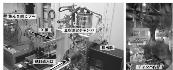
図5 開発に着手した真空測定システムの写真。
