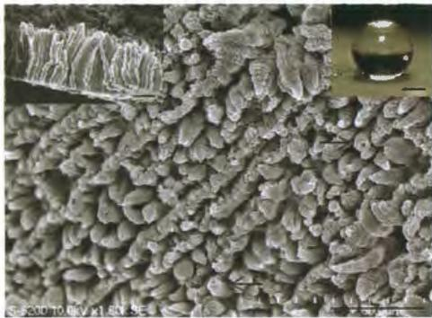
図3. 耐久性を有するポリアルキルピロールの超撥水表面の電子顕微鏡写真と、その上に置かれた水滴。スケールバーは、電子顕微鏡写真の場合は15  $\mu\text{m}$ 、水滴の写真では500  $\mu\text{m}$  である
