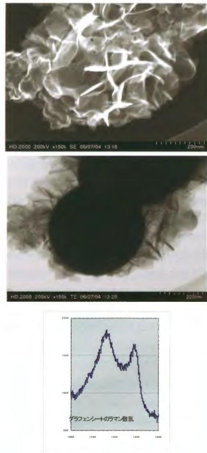
図19. 成長したグラフェンシートのSEM(上)、TEM写真(中)とラマン散乱スペクトル(下)。
