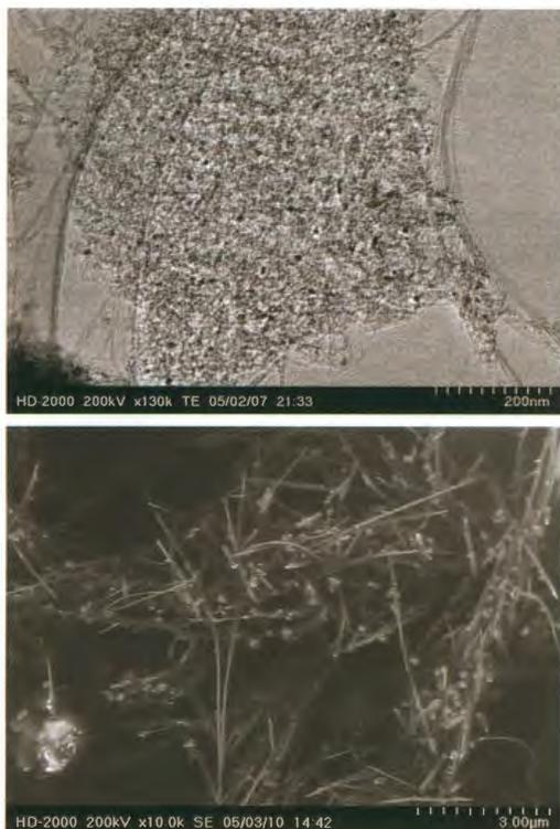
図11. 入手後処理をしていない二層 CNT (上)と精製・切断した二層 CNT の電子顕微鏡像 (下)。
