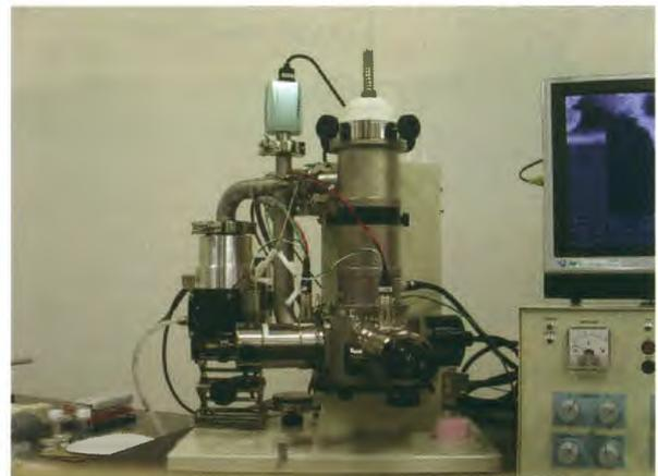
図16. 試作した超小型CNT-AFM探針作成装置。
