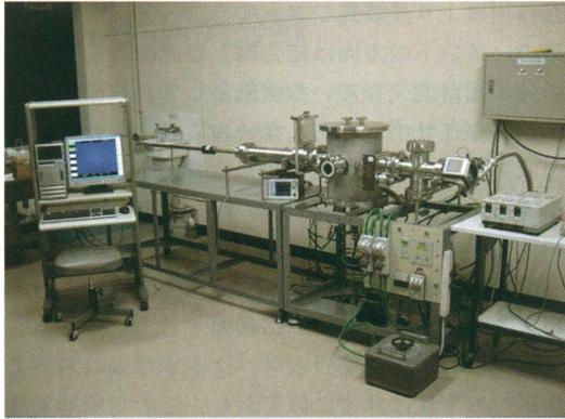
図7. 自作のEL発光素子作製装置
