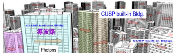
図4. CUSP・GEMを各部屋に組込んだビルで、2DPRCSにより発電することで、空調の対象となる太陽光起源の熱発生を未然に防ぎながら電力化することで、換気・空調によるエネルギーロスが極小で、太陽光を最大活用する新 Energo-environmental Systemを実現する。
