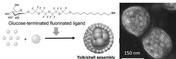
図4. フッ素化リガンドで修飾することで2つの粒子が自発的に溶液中でYolk/Shell構造を形成。
