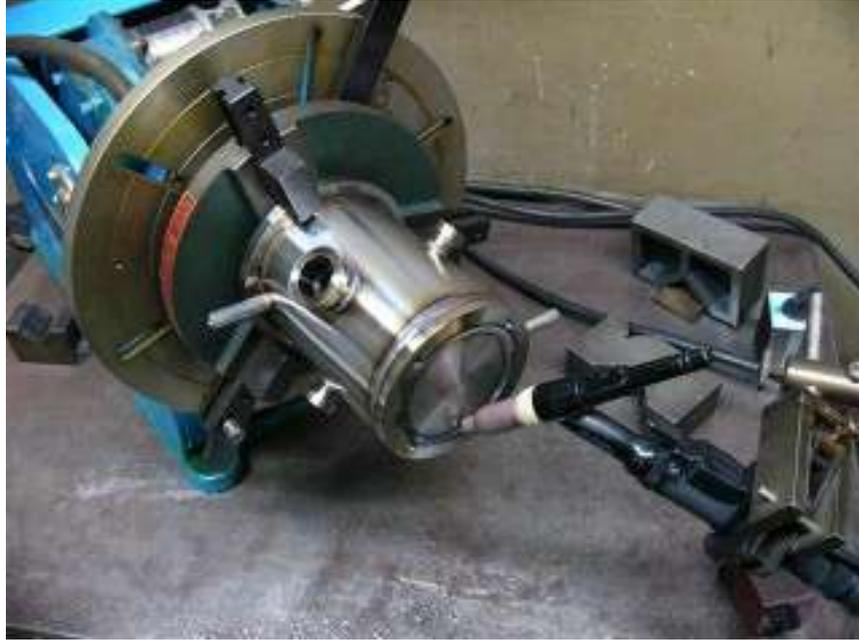
底面フランジを溶接して、ウォータージャケットを封じ込む
