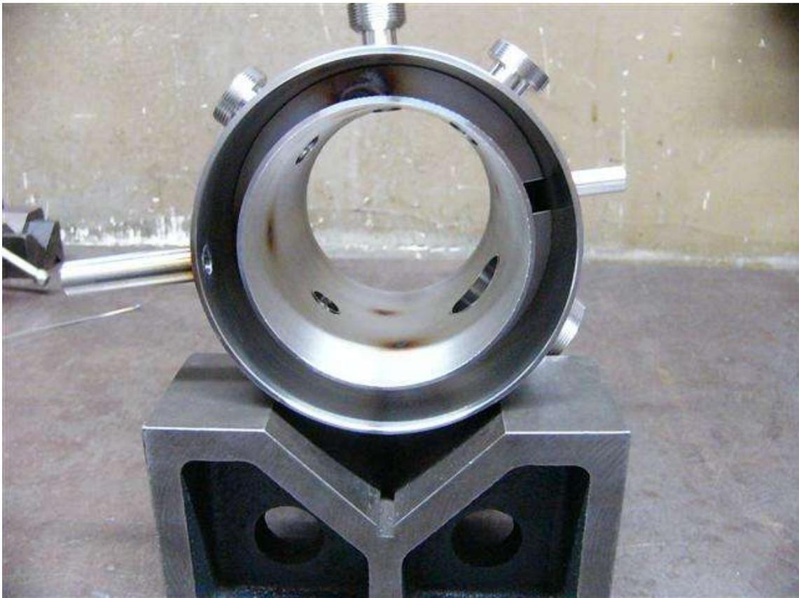
インナーパイプとアウトパイプを組み合わせ、各ポート類を仮組みする
