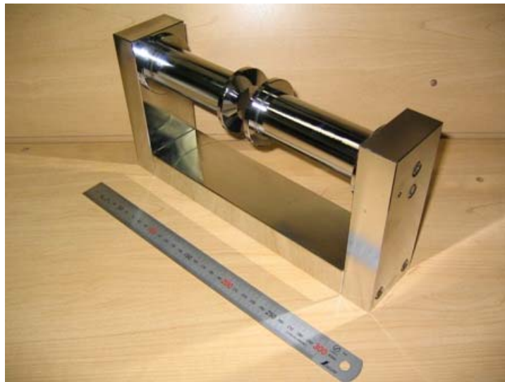
亜鉛メッキ処理後
