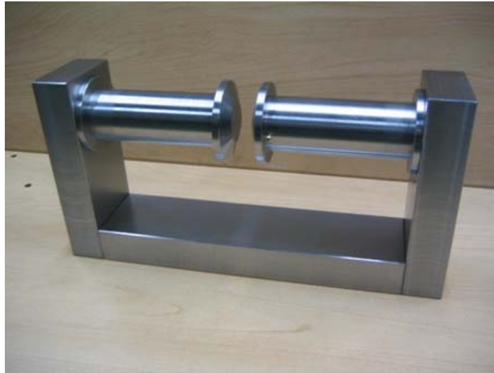
鉄心部ベース部切削加工後仮組立て 難削材であるため、切削加工が困難であった。
