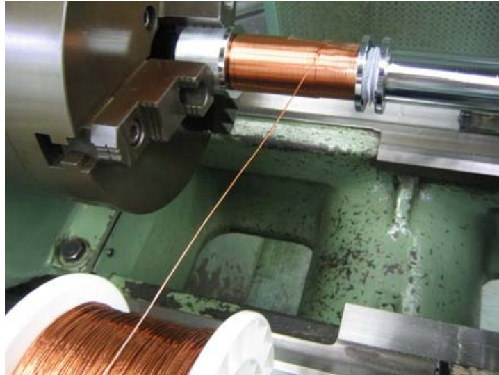
メッキ処理後鉄心部にコイル巻き付け
