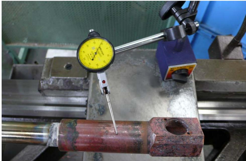
【内層 SUS パイプ-Cu ヒートユニット銀ロウ付け後の振れ測定】
