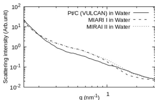
図3 SACLA コヒーレント X 線回折データの SAXS 解析。
