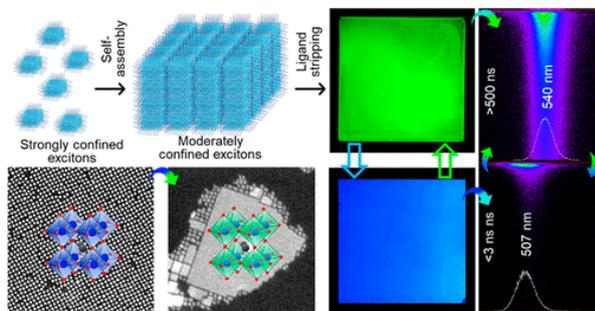
図3 自己組織化したホルムアミジニウム臭化鉛 (FAPbBr<sub>3</sub>) 量子ドットの、機械的に変化する励起子およびフォトルミネッセンス解明【資料4-1-1】
