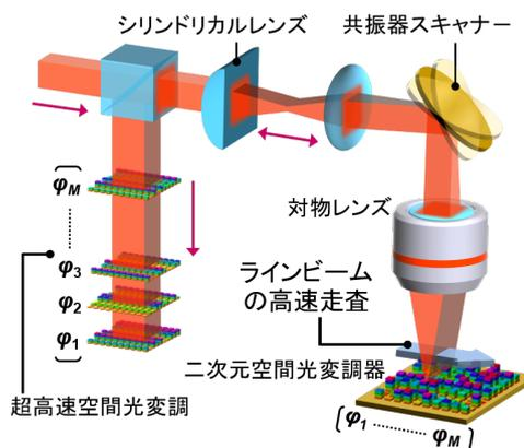
図3 超高速空間光変調手法。
