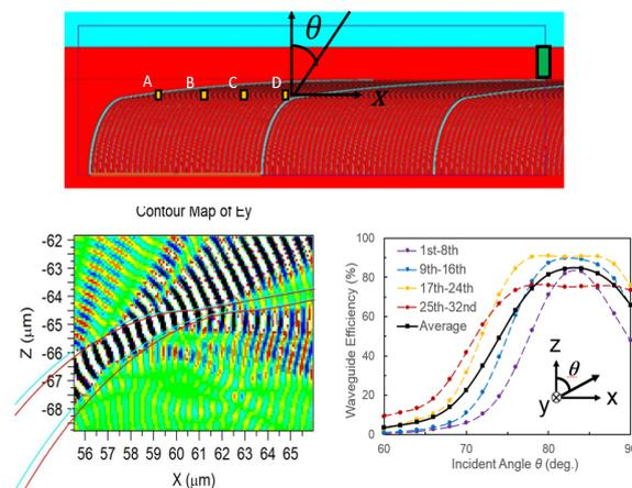
図2 分散的併進対称性導波路 (DTSWG) のシミュレーション。上) 構造図、系統図、左下) 縦長楕円から横長楕円へ切り替わる部分での光の導波の様子、右下) 縦長楕円から横長楕円へ切り替わる部分に光源を置いて出射角  $\theta$  を振ったときの2次元導波路内 (上図右上の緑色のモニター) への到達効率の計算結果。
