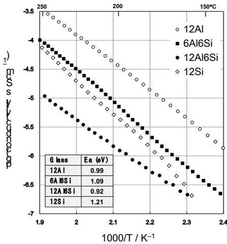
図3 APS後のアルミノケイリン酸ガラスの伝導度のアレニウスプロット
