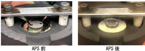
図1 Alkali-Proton Substitution (APS)法によるリン酸塩ガラスの処理前後の写真
