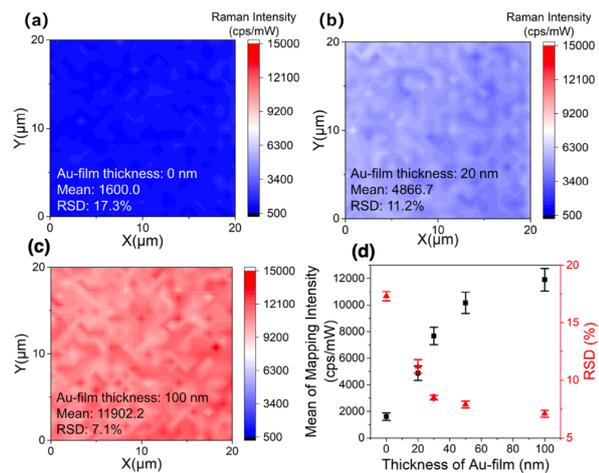
図2 ATAの金反射膜の膜厚を変化させたSERSチップを用いて計測したラマン強度マッピング：(a)金反射膜の膜厚0 nm、(b)20 nm、(c)100 nm。(d)金反射膜の膜厚に対するマッピングされたラマン強度の平均値、およびその相対的標準偏差。
