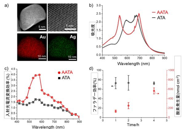
図1 (a)金銀合金ナノ粒子の透過型電子顕微鏡像 (上) とエネルギー分散型 X 線分光による元素マッピング (下), (b) AATA・ATA 電極の吸収スペクトル. 吸光度は 1 で 90%, 2 で 99%の光を吸収していることを指す. (c) AATA・ATA 電極を光陽極として用いた際の入射光電流変換効率. (d) AATA に可視光 (波長 400nm 以上) を照射した際の酸素発生量とファラデー効率.
