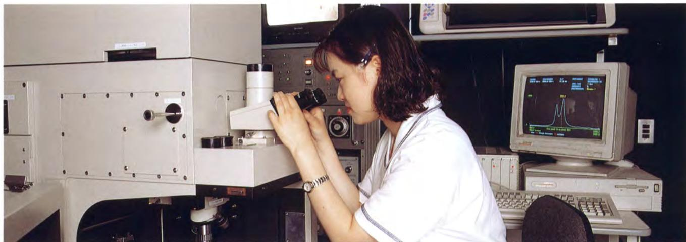
顕微ラマン装置による微小体積試料の測定
