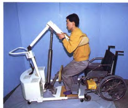
図3 水素吸蔵合金アクチュエータを利用した介助ロボット
