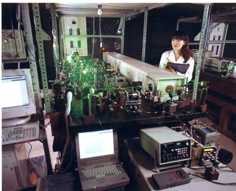
ピコ秒YLFレーザーによる超スローダイナミクス測定装置
