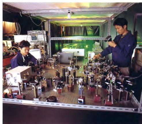
フェムト秒モードロックレーザーシステムによる超高速ダイナミクス測定装置
