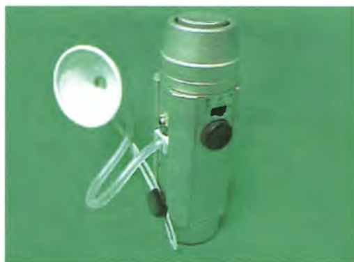
図1. 抑揚を制御できる電気式人工喉頭（ユア・トーン）
