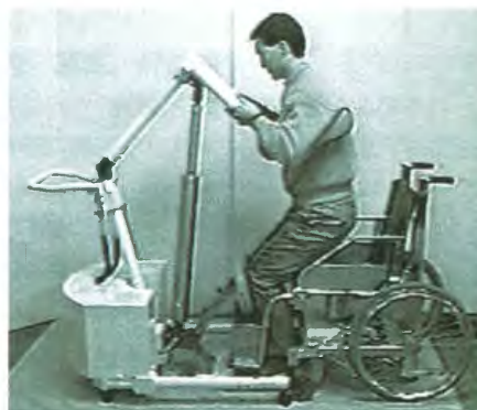
図4. 水素吸蔵合金（MH）を利用した移乗介助装置
