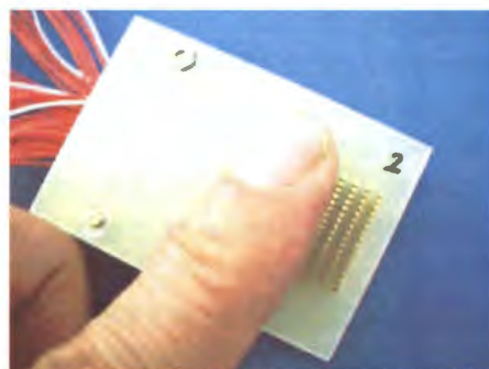
図3. 感覚代行のための廉価・低消費電力型振動子マトリクス
