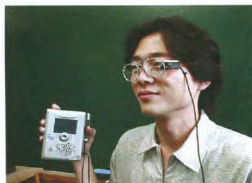
図3. 音声確認結果が話者の口元に表示されるシステム
