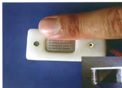
図2. 触覚インタフェースのための振動子マトリクス
