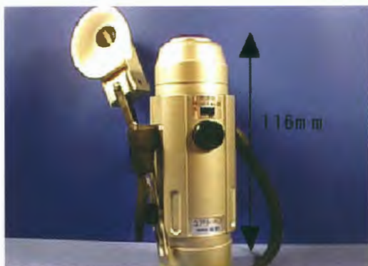
図1. 抑揚を制御できる改良型電気式人工喉頭版
