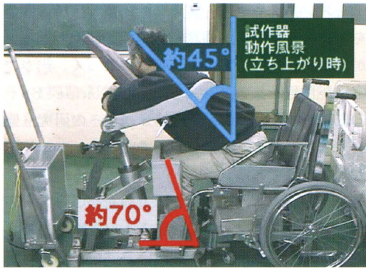
図4. 水素吸蔵合金（MH）を利用した移乗介助装置
